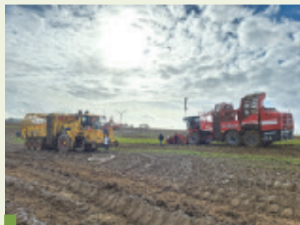
Figuur 2: links, een bunkerlader van 80 m 3 (4 assen), rechts een eenfasige bunkerrooier met 3 assen
