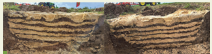
Figuur 4: links: Vooras, 4.4t/wiel, druk 1.1 bar; rechts: Achteras, 5.2t/wiel, druk 1.7 bar
