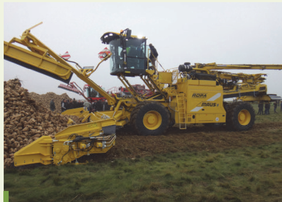
Foto 5: Vermijd spoorvorming op de plaats van de hoop om een toename van grondtarra en verliezen te voorkomen. 1 m 3 spoorvorming = 600 kg bieten!
