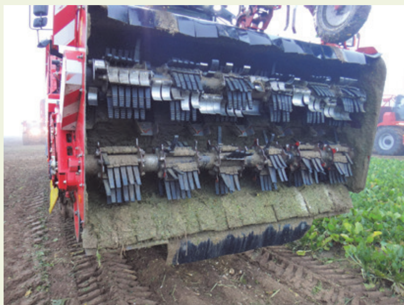
Foto 3 : Ontbladeraar met dubbele rotor. De stalen klepels verwijderen het grootste deel van de bladeren, terwijl de rubberen klepels de restanten verwijderen.
