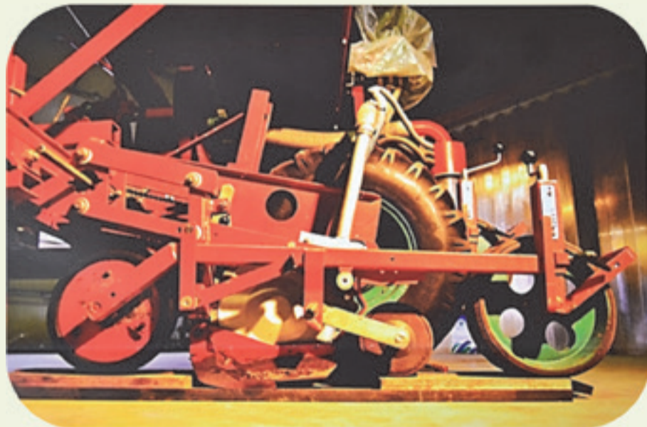
Figuur 2: Stel alle zaai- en zaai-voorbed voor het begin van het seizoen op dezelfde zaai- en zaai-voorbed diepte in. Controleer de zaai- en zaai-voorbed diepte tijdens het zaaien en pas aan indien nodig (foto: IRS).
