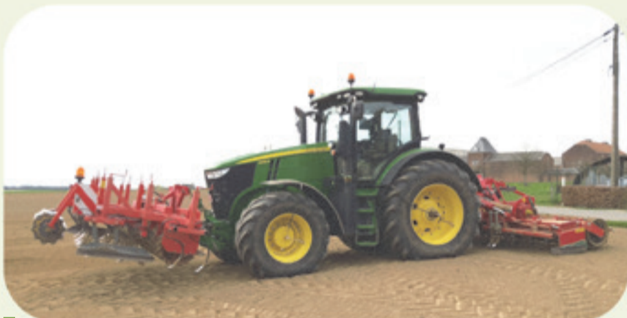
Figure 1 : Suivant le poids du chantier, choisissez la pression des pneus adaptée. Comme illustré sur la photo, en réduisant la pression des pneus, la surface de contact est augmentée tant en largeur qu'en longueur.
