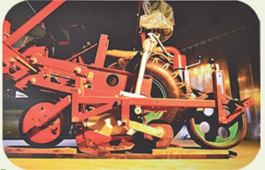
Figure 2 : Réglez tous les socs à la même profondeur de semis avant le début de la saison. Contrôlez la profondeur de semis lors du semis et ajustez éventuellement (Photo: IRS).
