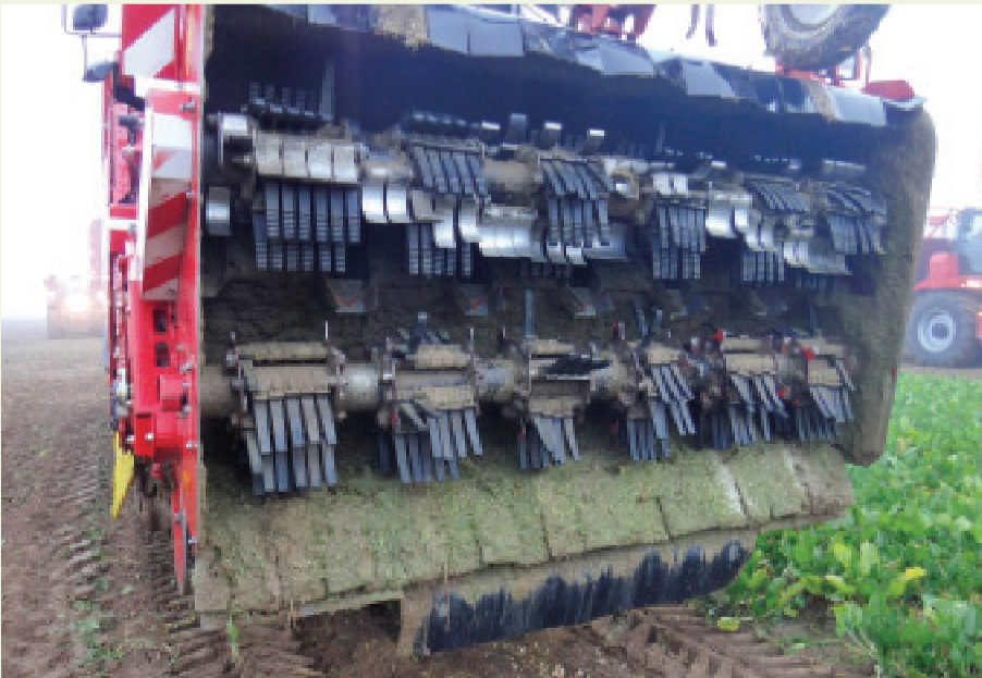
Photo 5: Effeuilleuse à double rotor. Les fléaux en acier enlèvent la plupart des feuilles tandis que les fléaux en caoutchouc éliminent les restes de feuilles.
