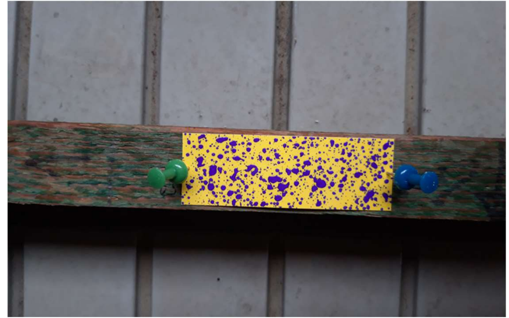
Spectre de pulvérisation sur papier hydrosensible
