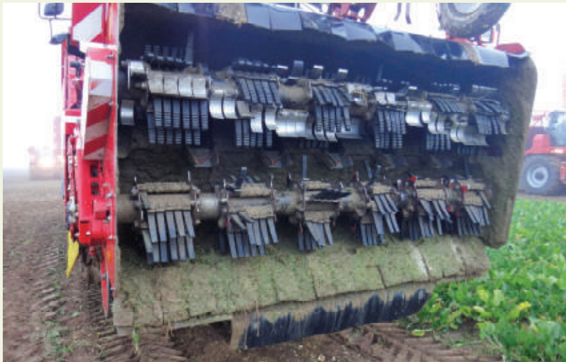
Figuur 4: Ontbladeraar met dubbele rotor. De stalen klepels verwijderen het grootste deel van de bladeren terwijl de rubberen klepels de laatste bladresten wegpooetsen.
