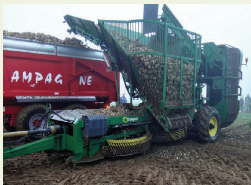
Figuur 3: Kies in functie van de rooiomstandigheden de gepaste machineuitrusting. De machine op foto is uitgerust met varkensstaarten ter hoogte van de eerste reinigingszon en standaard geleidingsrijers ter hoogte van de tweede reinigingszon. Varkensstaarten kunnen beter reinigen in vochtige omstandigheden. Let ook op de afstand tussen geleidingsstelsel en reinigingszon alsook de draaisnelheid van de verschillende onderdelen.
