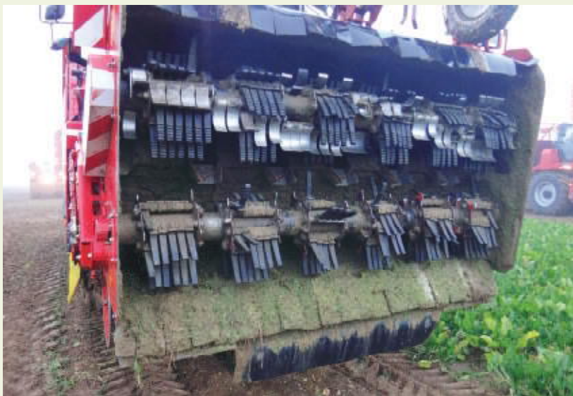
Photo 4: Effeuilleuse à double rotor. Les fléaux en acier enlèvent la plupart des feuilles tandis que les fléaux en caoutchouc éliminent les restes de feuilles.
