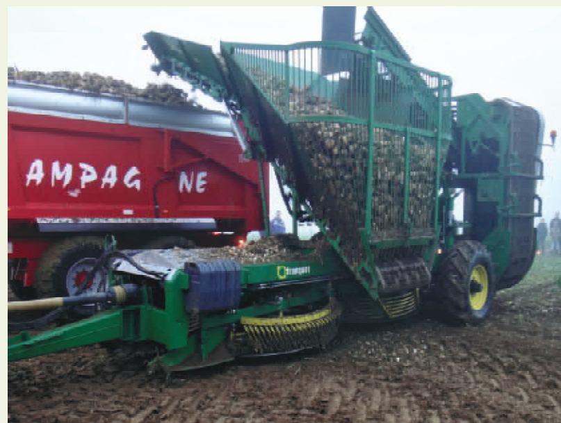
Figure 3: Sélectionnez l'équipement de machine approprié en fonction des conditions de récolte. La machine sur la photo est équipée de queues de cochon au premier soleil de nettoyage et de barres de guidage standard au deuxième soleil de nettoyage. Les queues de cochon peuvent mieux nettoyer par temps humide. Notez également la distance entre le système de guidage et le soleil de nettoyage, ainsi que la vitesse de rotation des différents composants.
