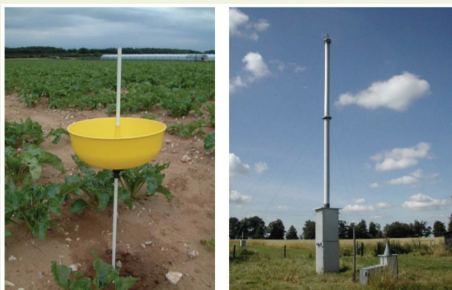
Figure 2: A gauche, un piège jaune et à droite, un piège à suction. Ces deux pièges permettent de capturer des pucerons (verts) ailés.
