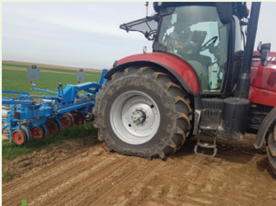
Figure 4 : Suivant le poids du chantier, choisissez la pression des pneus en consultant le tableau de pression. Comme illustré sur la photo, en réduisant la pression des pneus, la surface de contact est augmentée tant en largeur qu'en longueur.
