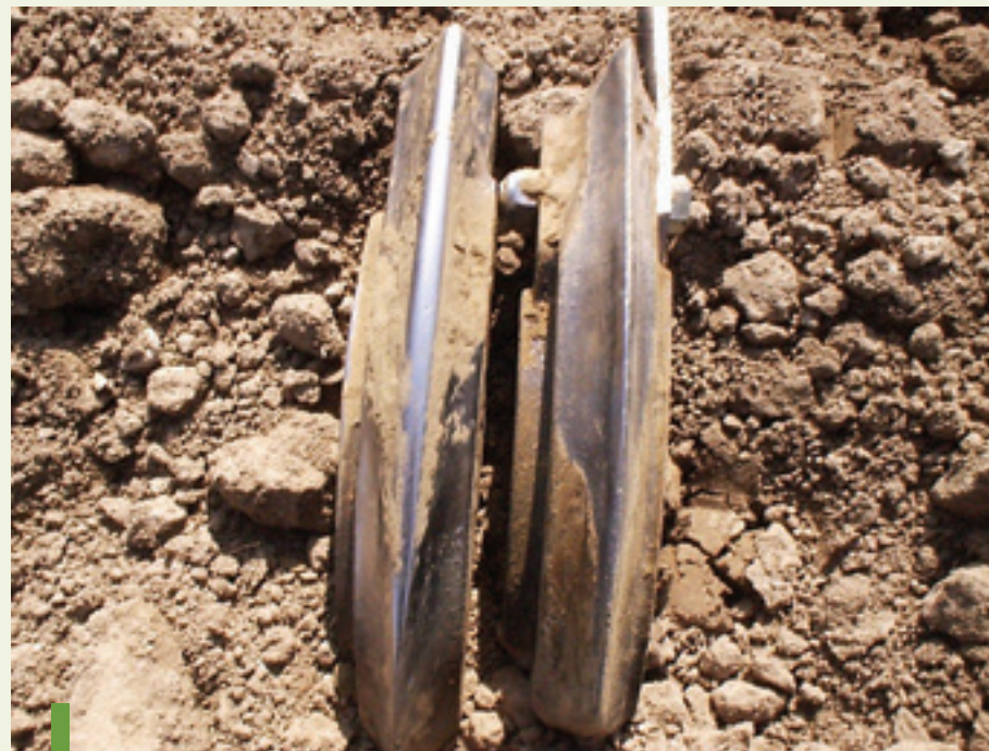
Figure 6 : A gauche, un soc de semis usé et à droite, un nouveau soc de semis. Un soc usé fait un sillon trop large dans lequel les graines peuvent rouler latéralement ou dans le sens du semis. Cela engendre une mauvaise précision et peut aussi causer un mauvais appui des graines dans le sol.
