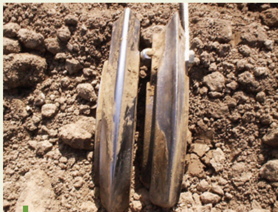
Figuur 6: Links een versleten zaai- en zaaimachine, recht een scherpe zaai- en zaaimachine
