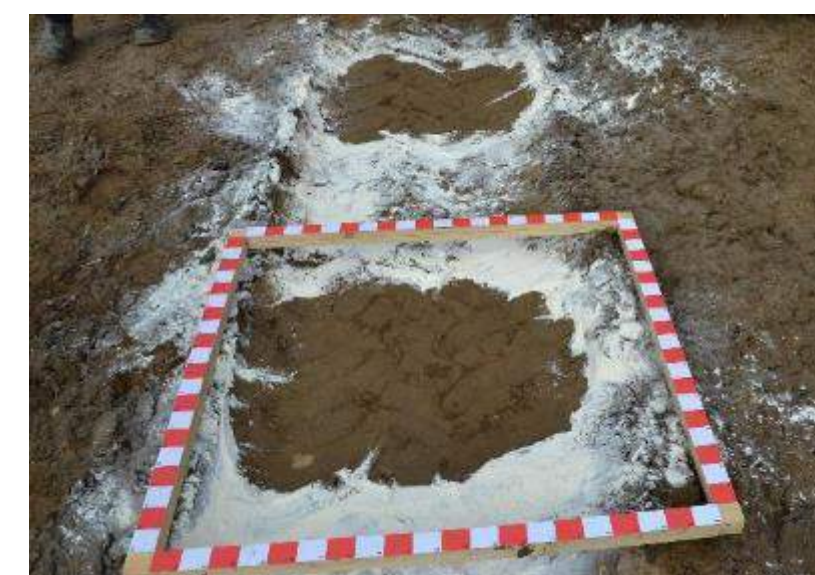
Voorwiel : 1.480 kg – 0,6 bar Achterwiel : 4.270 kg – 1,3 bar Wiel 1: 4.920 kg – 0,9 bar Wiel 2: 6.010 kg – 1,3 bar
