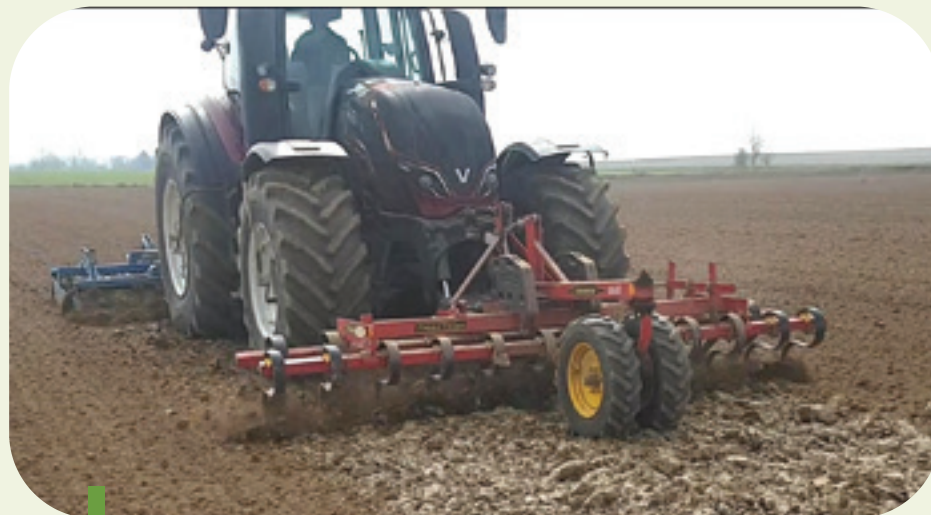
Foto 2: Door frontwerkhuizen beperk je het aantal doorgangen. De betere gewichtsverdeling in combinatie met een luchtdrukwijsysteem vermindert de druk op de bodem
