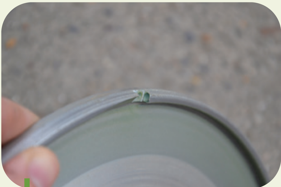
Foto 4: Controleer alle onderdelen van het zaai-element die in contact komen met het zaad. Slijtage veroorzaakt missers, dubbels en gebroken zaad.
