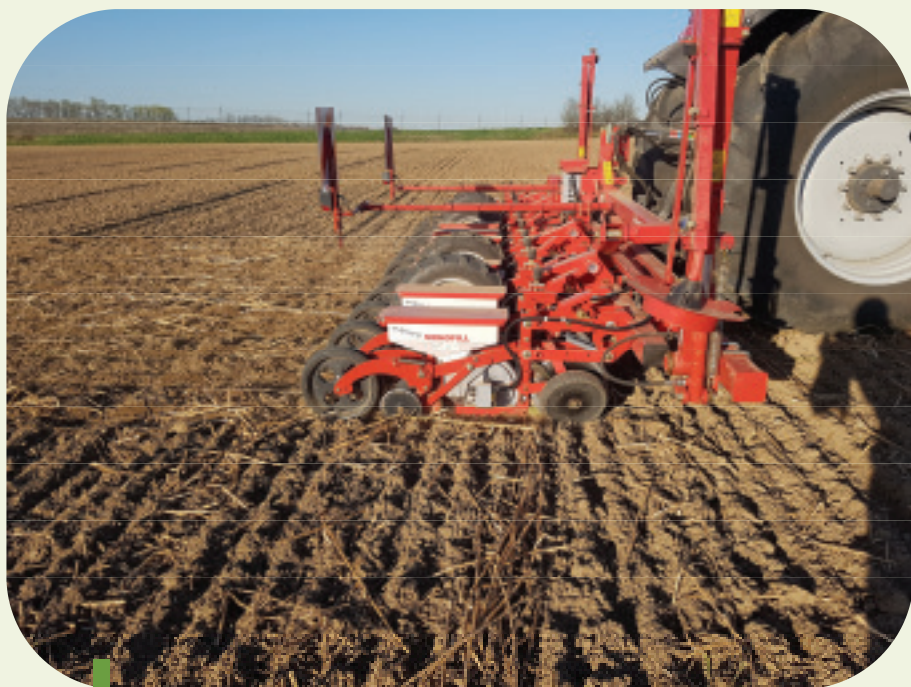
Foto 3: Snijschijven op de zaaimachine snijden de nog aanwezige gewasresten door zodat het risico op verstoppingen vermindert
