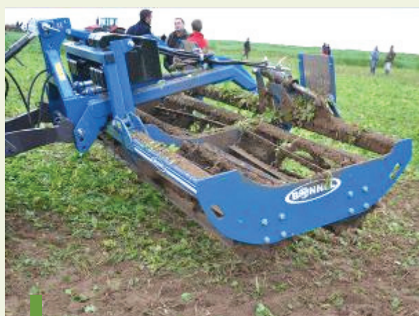
Construction frontale avec 2 rouleaux ouverts avec des couteaux tranchants. Un poids supplémentaire est important pour bien couper.
