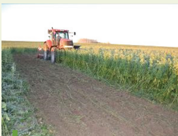
En cas d'un couvert bien développé, un déchaumeur à disque peut aussi donner de bons résultats.
