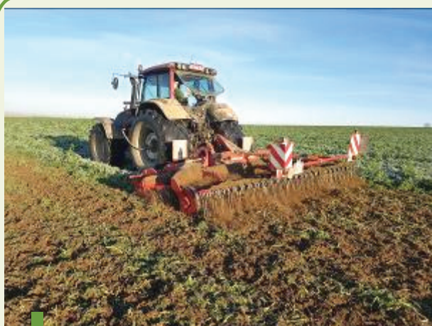
Un déchaumeur à disques enfouit superficiellement les résidus du couvert avec une capacité élevée.
