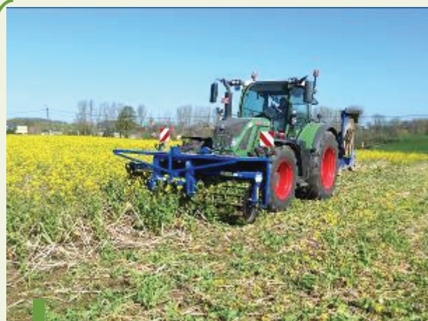
Rouleau de grand diamètre avec couteaux tranchants perpendiculaires. Ici les couteaux sont démontables.
