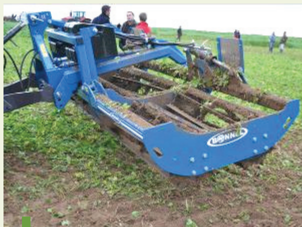
Frontbouw met 2 open rollen met scherpe messen. Extra gewichten zijn belangrijk om goed te snijden.
