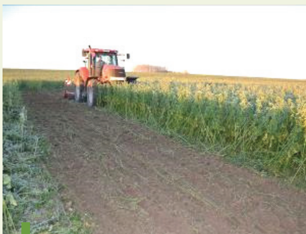
Ook in sterk ontwikkelde groenbedekker kan een schijfeg goed werk leveren.
