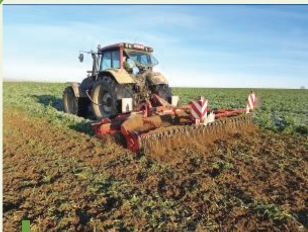
Een schijfeg werkt groenbedekkerresten oppervlakkig onder met hoge capaciteit.
