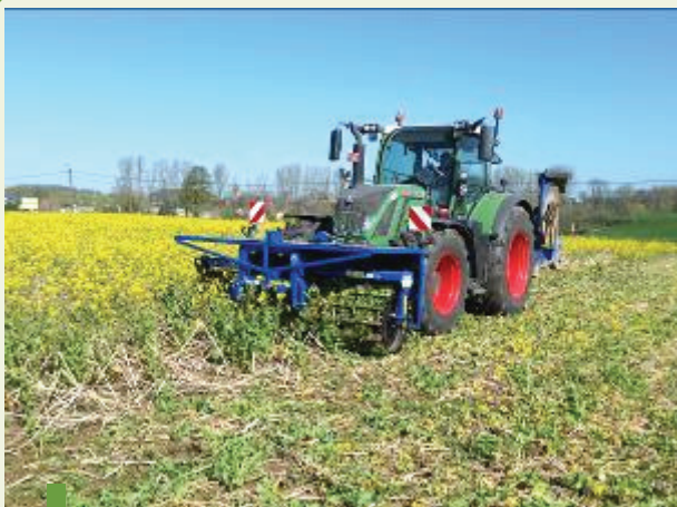
Rol met grote diameter met daarop haaks gemonteerde scherpe messen. Hier zijn de messen demonteerbaar.
