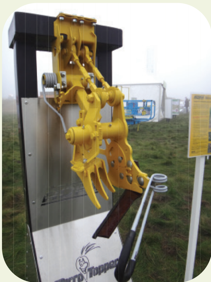
Micro ontkopper. Visueel is er weinig verschil tussen oude en nieuwe ontkopsystemen (hier op foto). Het werkingsmechanisme is echter wel verschillend. Bij het naar beneden bewegen van een micro-ontkopper, wordt de afstand tussen kam en mes kleiner en wordt er een dunner schijfje afgesneden.
