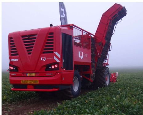
Type Q-serie 616 of 621. Modulaire opbouw 1 wiel per spoor
