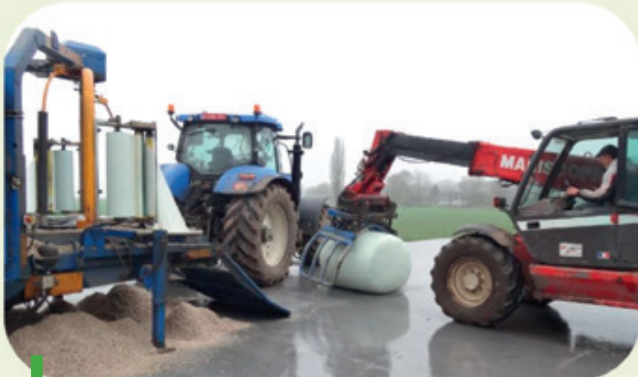
Gewikkelde baal (capaciteit: \pm 1 ton/baal), moeilijk aan te leggen indien de droge stof van de pulp < 24\% is. Deze techniek is alleen bedoeld voor kleine dagelijkse behoeften aan pulp
