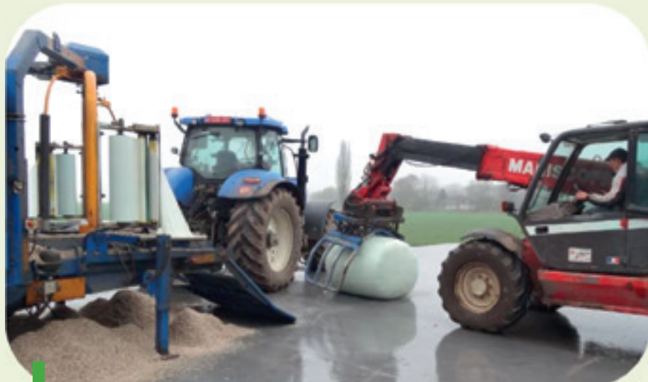
Balle enrubannée (capacité: \pm 1 tonne/balle), difficile à réaliser si la matière sèche de la pulpe est < 24\% . Cette technique n'est envisageable que pour des faibles besoins en pulpe journalier.
