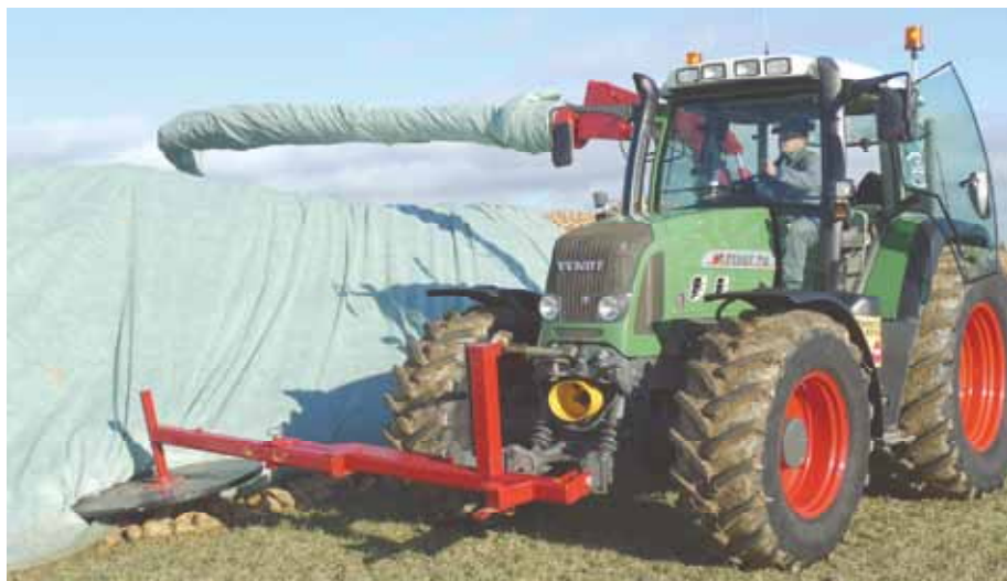
Figuur 9. Mechanisatie van het afdekken en verwijderen van Toptex-dekzeilen van bietenhoppen, en een systeem om het zeil aan de voet vast te leggen, ontwikkeld door een Belgische landbouwer en voorgesteld op Betteravenir in oktober 2011.
