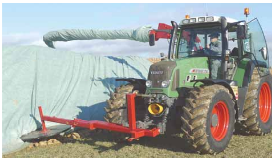
Figure 9. Mécanisation du bâchage et du débâchage des tas de betteraves avec Toptex, et système de fixation au pied du tas développé par un agriculteur belge et présenté à Betteravenir en octobre 2011.
