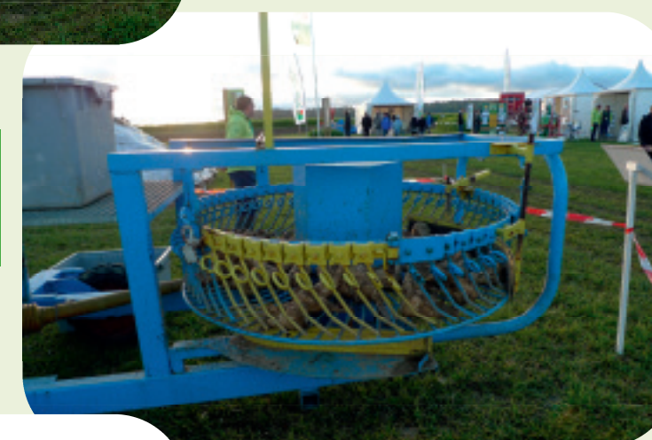
La turbine est utilisée pour simuler différents niveaux de blessures des betteraves dans le cadre des essais de stockage.
