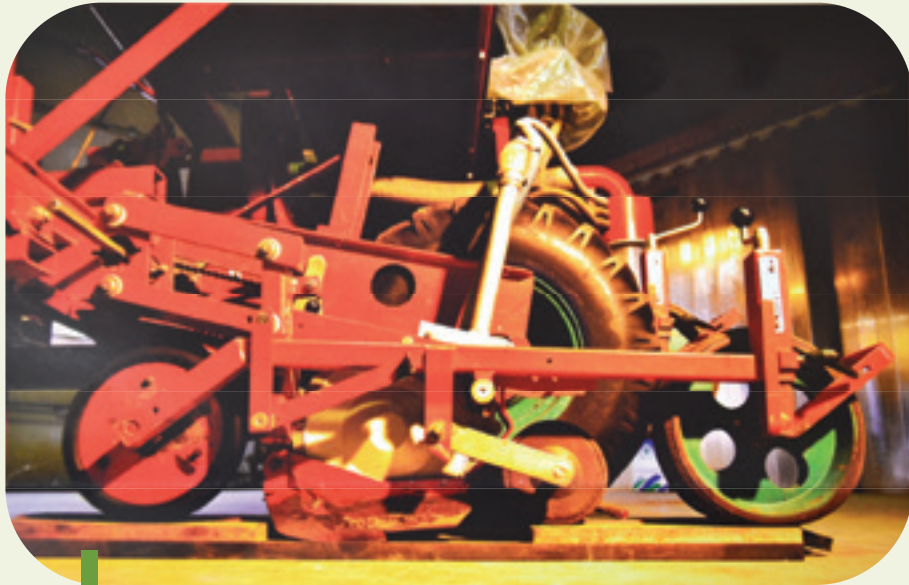
Stel alle kouters af op dezelfde diepte voor start van het seizoen. Controleer zaaidiepte bij zaai en stel eventueel bij (Foto: IRS).
