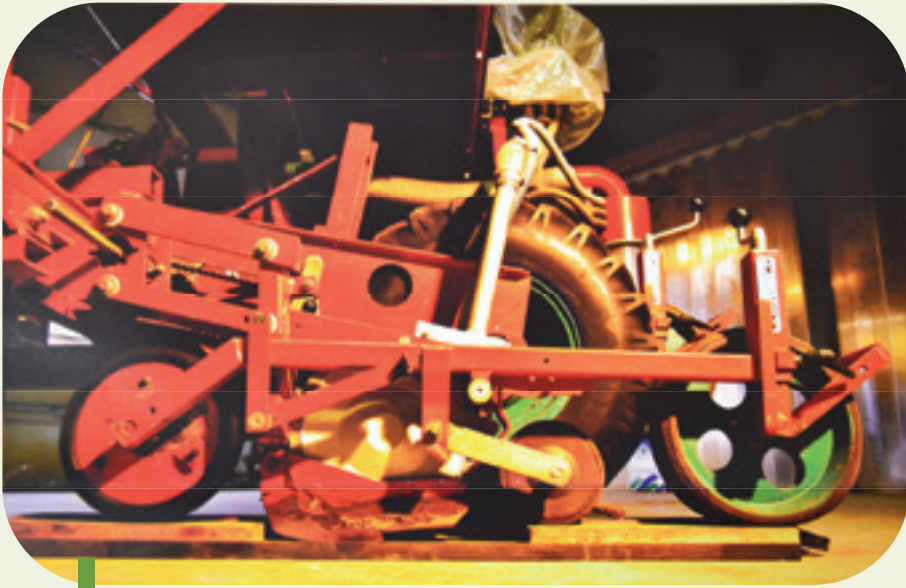
Réglez tous les socs à la même profondeur de semis avant le début de la saison. Contrôlez la profondeur de semis lors du semis et ajustez éventuellement (Photo: IRS).
