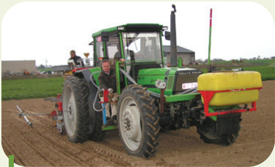
Figuur 3. Door de toediening van minerale stikstofbemesting in de rij op het moment van de zaai kan de aanbevolen dosis met 20 tot 30% verminderd worden (proefmateriaal KBIVB).
