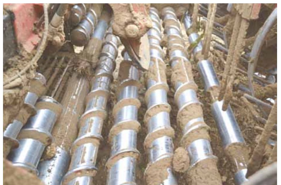
Foto: zicht op een reinigingstafel met axiaalrollen.
