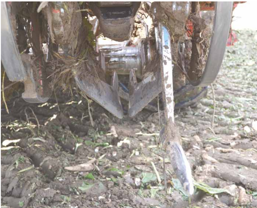
Foto: frontaal zicht op aangedreven rooischaar met diepwoelertand
