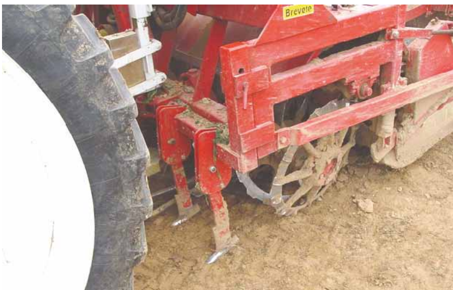
Foto: zicht op een Oppelwiel met diepwoelertanden.
