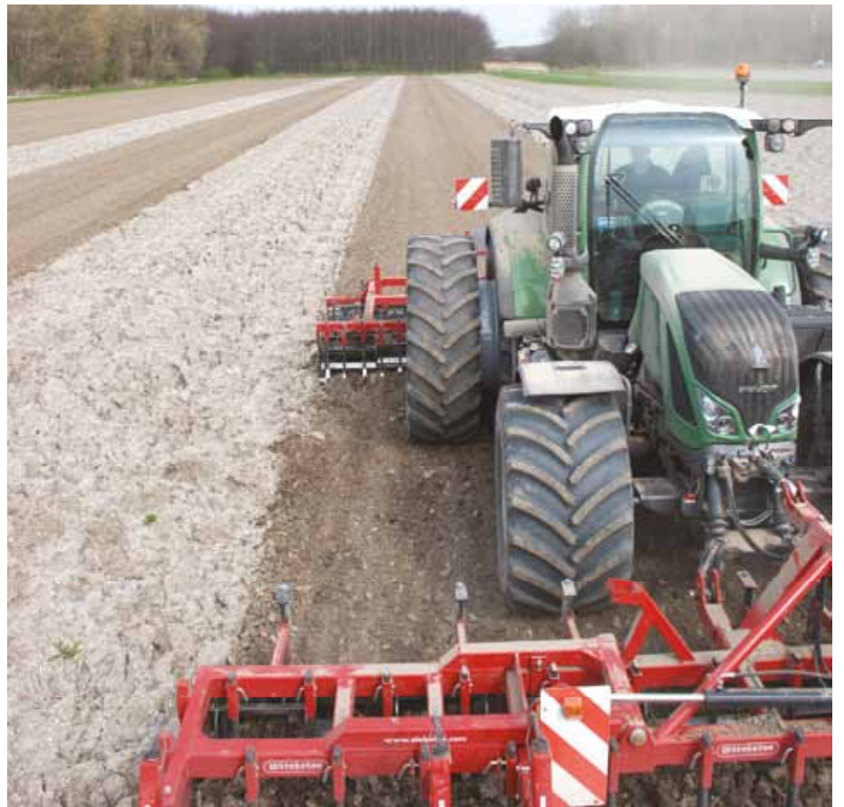
Photo 3: Avec un système GPS, non seulement on évite les redoublages, mais on peut également alterner les passages et réduire ainsi les manœuvres en bout de champ. Cela réduit la compaction du sol à ces endroits et constitue un réel gain de temps. Photo: www.SBG.nl
