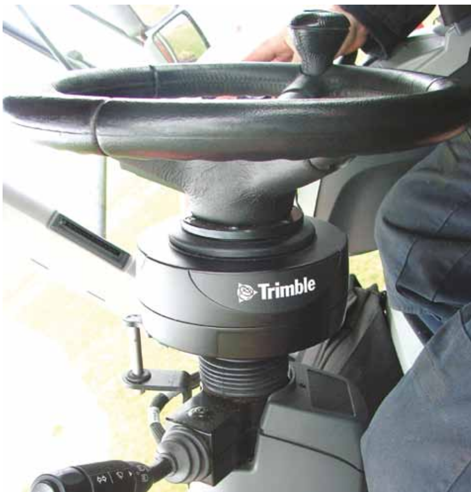
Photo 1: Moteur électrique intégré dans le système de direction. Photo: Agrometius
