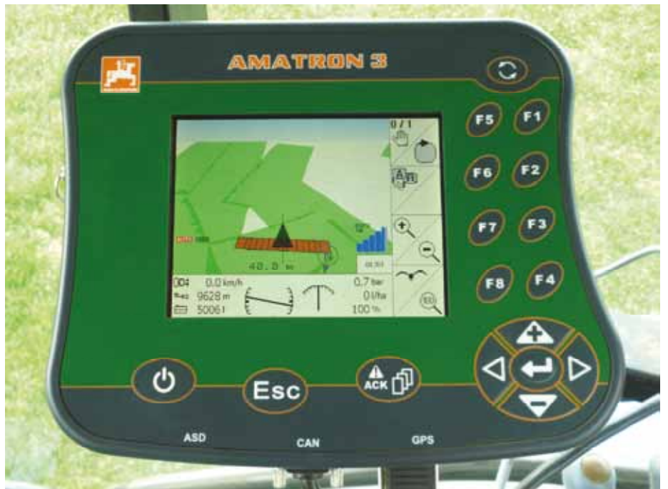
Photo 5: GPS-switch de Amazone. Un signal GPS commande la coupure de section d'un pulvérisateur. Les sections sont identifiées en rouge lorsqu'elles sont désactivées. On observe que les redoublages sont limités à un minimum (couleur vert foncé). Les sections de pulvérisation sont d'environ 3 mètres de large et sont désactivées si leur largeur complète dépasse une zone précédemment traitée. Photo: IRBAB
