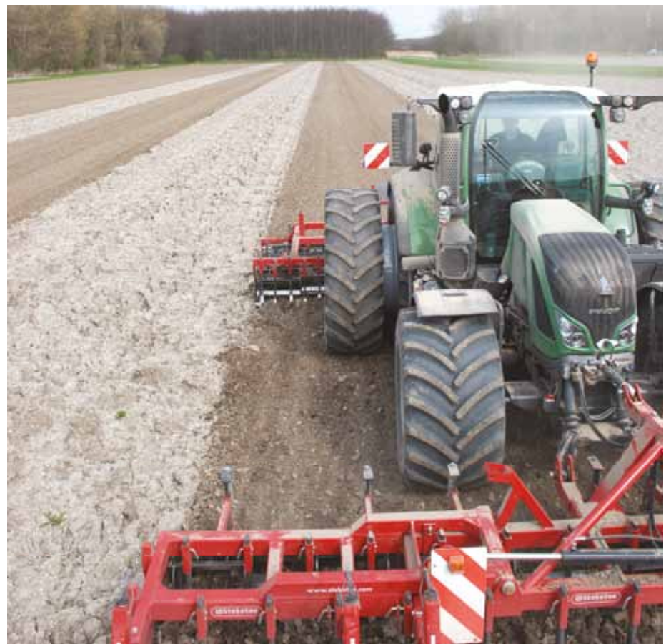
Foto 3 : Niet alleen vermijdt men overlap, men kan ook werkgangen overslaan bij het keren op de kopakker. Hierdoor vermindert de bodemverdichting en wordt er een tijds winst geboekt. Foto: www.SBG.nl
