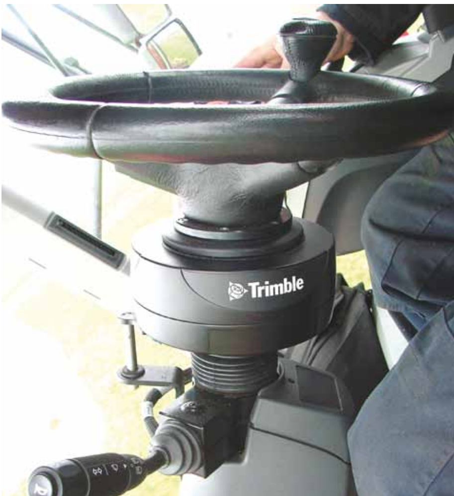
Foto 1 : Ingebouwde elektrische motor in stuursysteem. Foto: Agrometius
