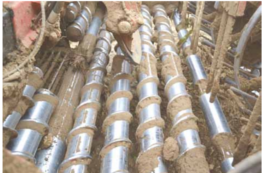
Photo : vue sur une table de nettoyage avec rouleaux axiaux.
