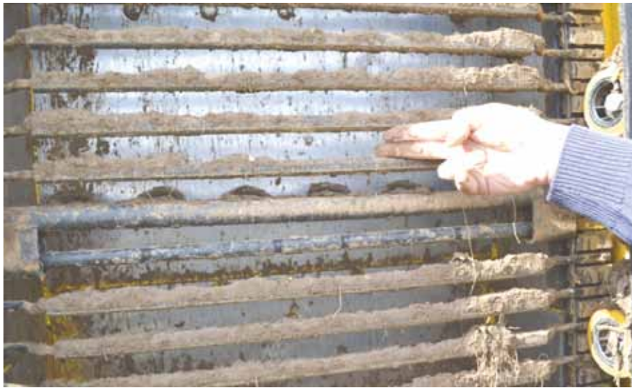
Photo : tapis adapté à l'arrachage de chicorées.
