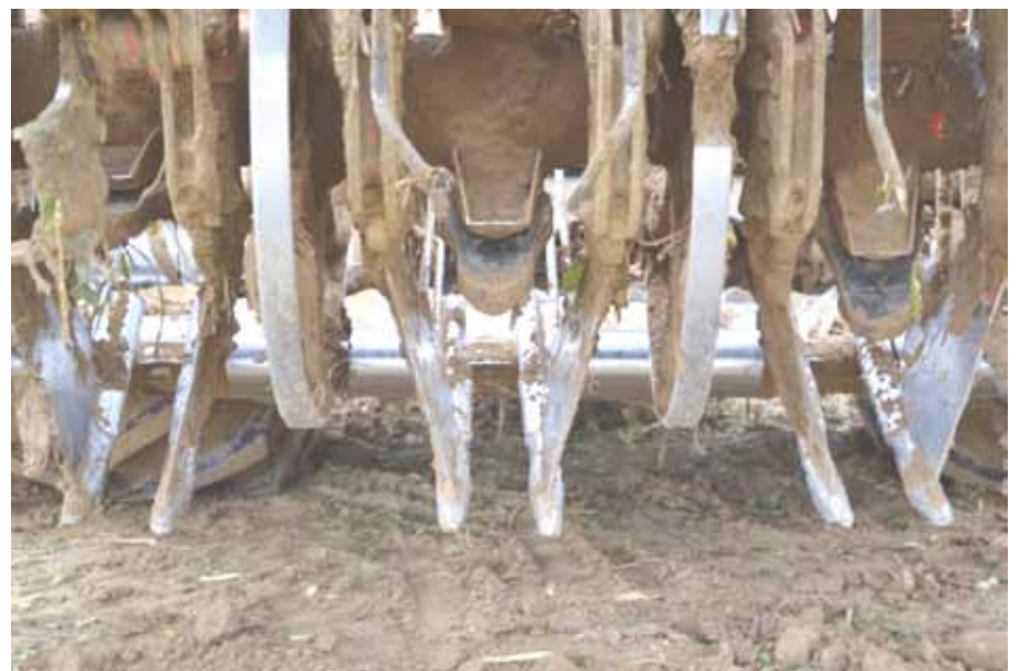
Photo : vue frontale de fourches oscillantes.
