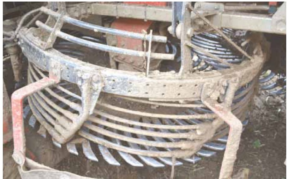
Photos : soleils adaptés à l'arrachage de la chicorée.
