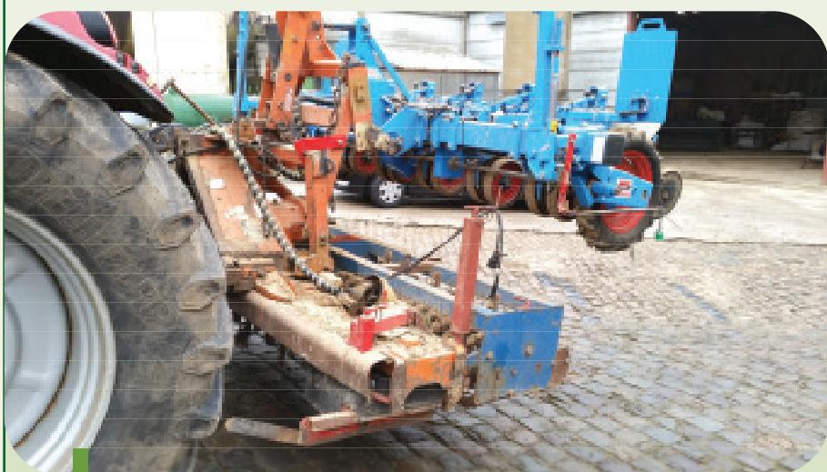
Figure 12: Le semoir utilisé pour la betterave et pour la chicorée est attelé à une herse rotative modifiée. Les graines tombent ainsi dans un sol humide.
