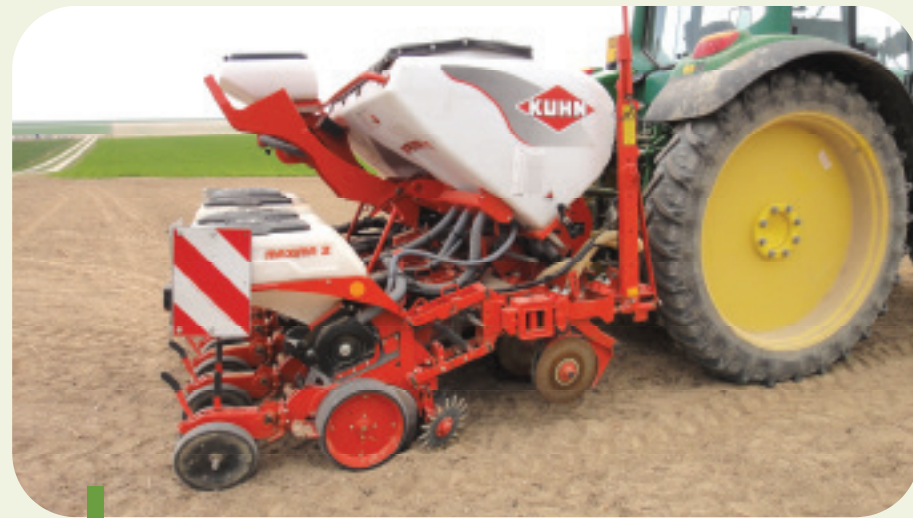
De proeven tonen dat de laatste generaties van pneumatische zaaimachines van bepaalde constructeurs de precisie van zaadaflegging van de beste mechanische zaaimachines benaderen.
