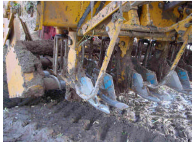
Fig. 2.18: Fourches fixes spécifiques à la chicorée (Agrifac: voir § 2.8.5)
