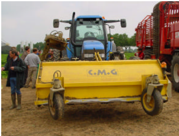
Fig. 2.31: Système d'arrachage en deux phases avec fourches spécifiques
