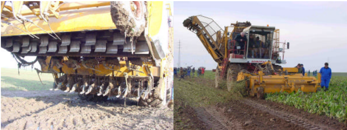
Fig. 2.27 et 2. 28: Agrifac. Equipée de fourches fixes et d'une installation de nettoyage hybride
