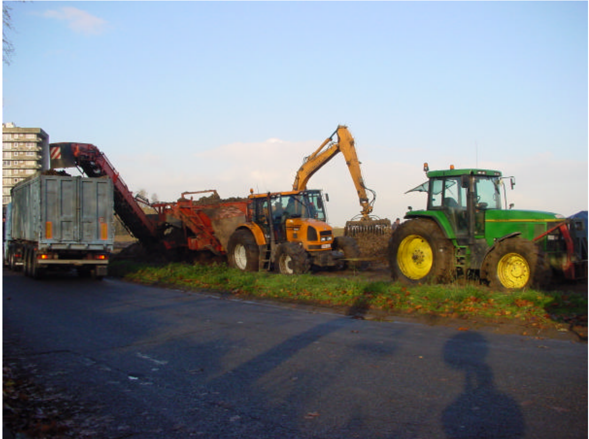
Fig. 2.33: Chargement des racines en utilisant des déterreurs
