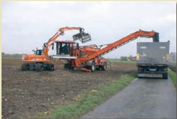
Opstelling van de bietenhoop voor een goede werking van een siloreiniger met bunker vooraan (volgens document TEREOS)
