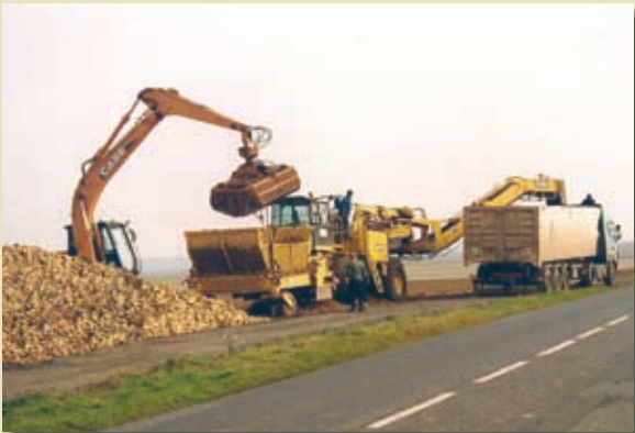
Opstelling van de bietenhoop voor een goede werking van een siloreiniger met bunker vooraan (volgens document TEREOS)
