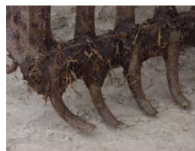
Figuur 1. Vergelijkende studie van Delvano-grijpers (met 2 verschillende inhouds) gecombineerd met een getrokken siloreiniger, op de hoeveelheid gebroken wortels (opbrengstverliezen uitgedrukt in % bruto gewicht)
