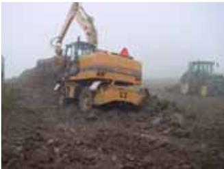
En mauvaises conditions les grues ont régulièrement des **problèmes d'adhérence**. Pour avoir une visibilité optimale le grutier positionne très souvent l'ensemble cabine, flèche grappin vers l'arrière de la grue. Les pneumatiques travaillent alors dans le sens inverse de la traction. Il n'y a pas vraiment de solution à ce problème si ce n'est inverser le sens des pneumatiques.
