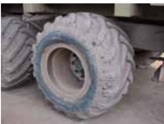
Les **pneumatiques larges** sont une alternative intéressante. A l'exception des terres argileuses, les roues jumelées peuvent également être envisagées. Le choix doit alors se porter sur des carcasses diagonales et non radiales. Par mauvaises conditions climatiques, les grues équipées de roues jumelées perdent la terre agglomérée entre les roues sur la route. Ceci constitue un sérieux inconvénient.
