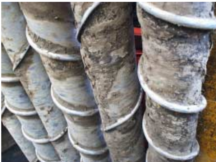
Photo 1. Vue d'un set de rouleaux axiaux qui remplace une turbine sur une machine de récolte une phase
