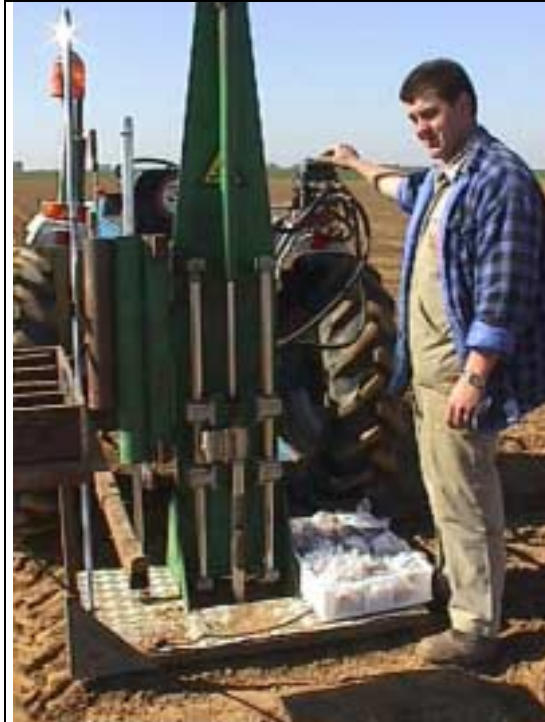
Figuur 3. Het KBIVB heeft zich uitgerust met een hydraulische boor die tot 1,50 m diepte kan gaan om de stikstofbemesting van de biet in de proeven beter te kunnen bestuderen.
