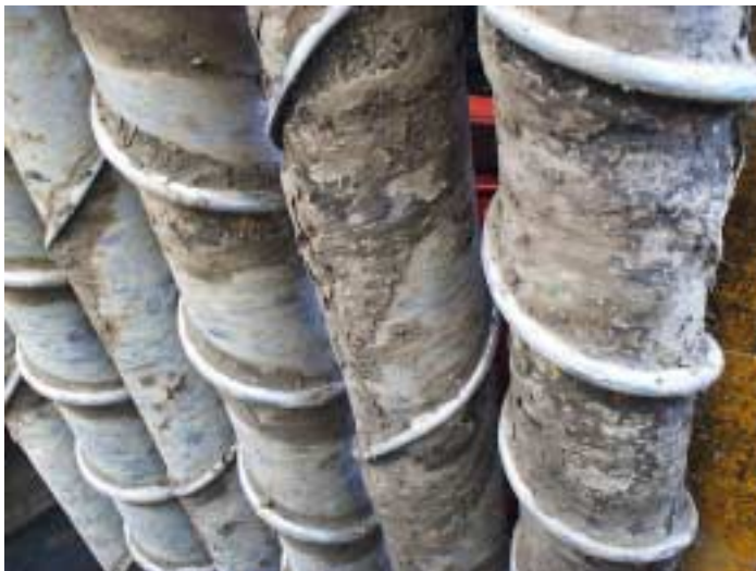
Foto 1. Zicht van een rollenbed dat een zeefrad in een eenfazig rooimaterieel vervangt
