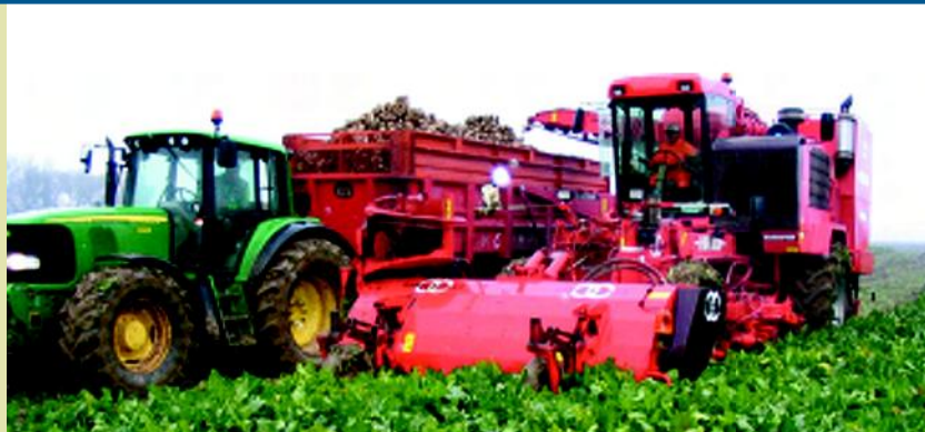
Machine de type "automotrice" à 2 essieux, équipée d'une trémie de 5.5 m 3 et animée par un moteur de 355 CV.
