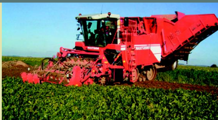
Machine de type " intégrale " à 2 essieux dont un à chenilles, équipée d'une trémie de 30 m 3 et animée par un moteur de 456CV.
