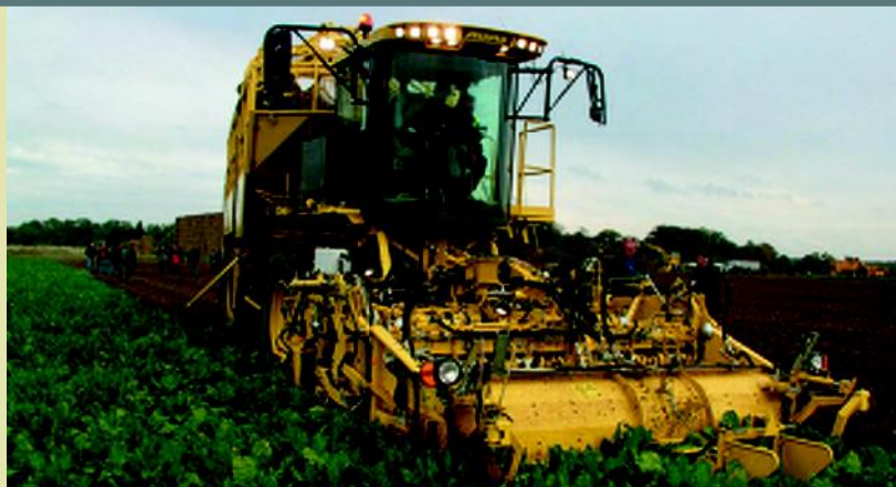
Machine de type " intégrale " à 6 roues motrices équipée d'une trémie de 40 m 3 et animée par un moteur de 593CV.
