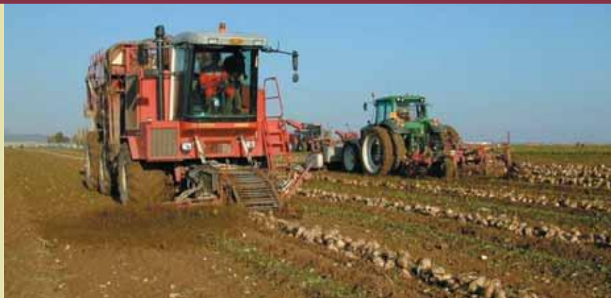
Chantier de type décomposé comprenant une effeuilleuse mono ou bi-rotor, une arracheuse-andaineuse avec 3 turbines et une débardeuse de 16 ou 25 tonnes.
