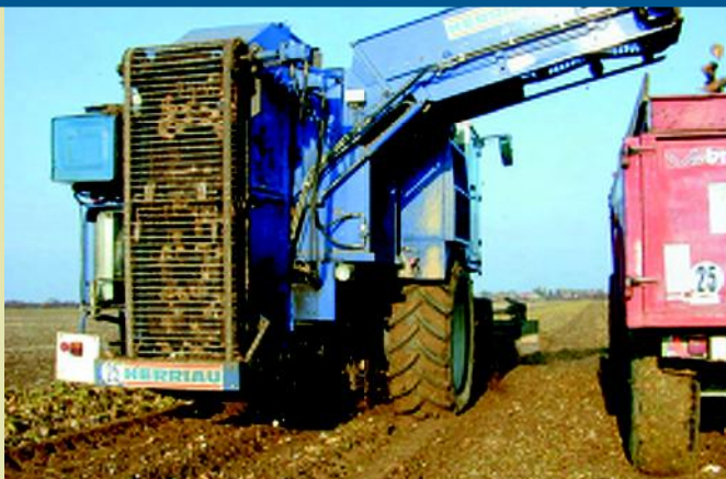
Machine de type "automotrice" à 4 roues motrices, équipée d'une trémie de 5 m 3 et animée par un moteur de 360 CV.
