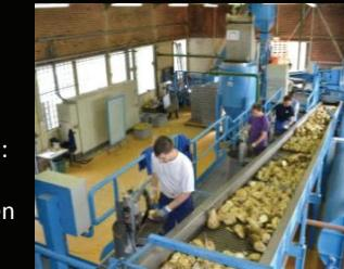
Een VENEMA analyseketen voor de bepaling van het suikergehalte en de melassevormende elementen (K, Na,  $\alpha$ N). De stalen worden dubbel geanalyseerd.
