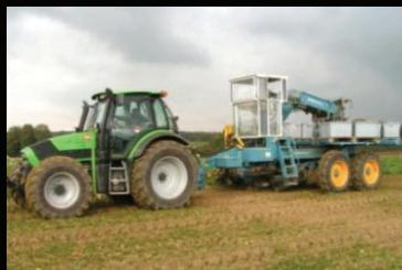
Een getrokken EDENHALL 4-rijige rooier aangepast voor proefpercelen (4 rijken = 10 m<sup>2</sup> = 80-125 kg). Rooier voorzien van trilscharen, reinigingszonnen, rollen met vingers of axiaalrollen en capaciteit voor 24 bakken.
