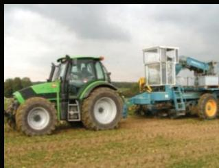
Une arracheuse tractée 4 rangs EDENHALL adaptée pour parcelles expérimentales (4 rangs = 10 m<sup>2</sup> = 80-125 kg) Arracheuse munie de socs animés, turbines, rouleaux à doigts ou axiaux, et 24 bacs de récolte.
