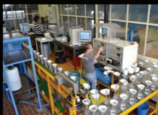
Une chaîne d'analyse VENEMA pour déterminer la richesse et les éléments mélassigènes (K, Na, αN). Analyse en double.
