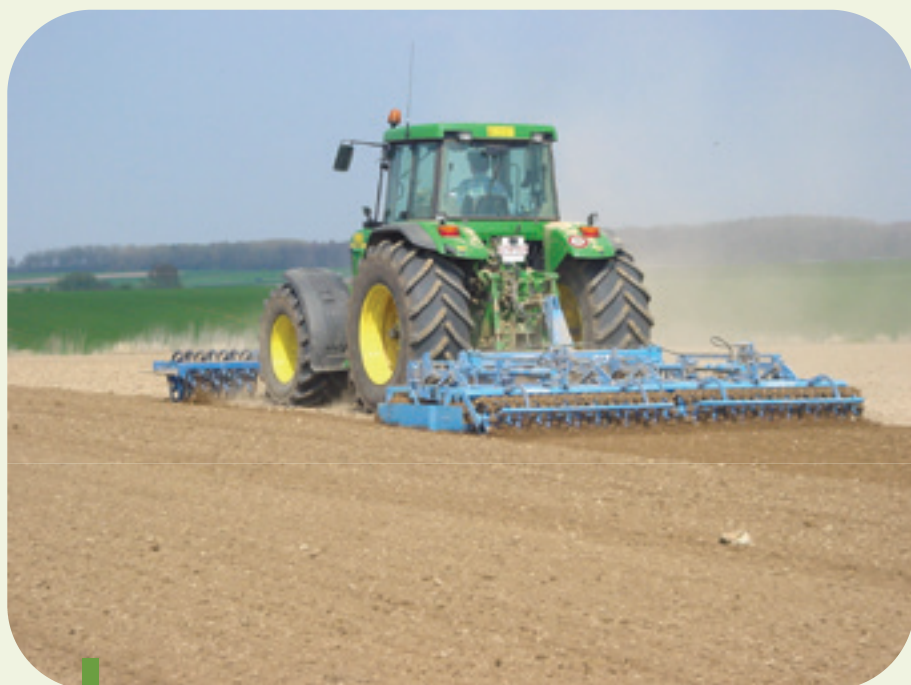
Figuur 4: Een niet aangedreven werktuig met tanden, verkruiemrollen en een aandrukrol.
