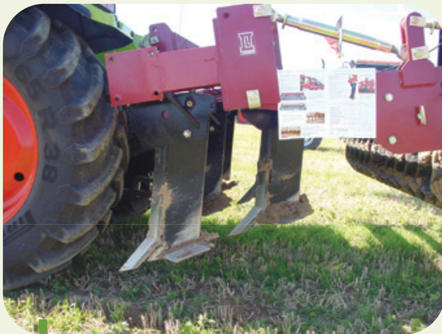
Figuur 9: Decompactor met twee rijen tanden.
