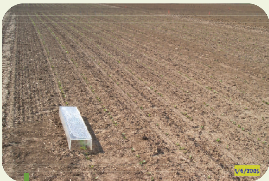
Figuur 7: Proef uitgevoerd door C. Roisin 2005. Er werden opvangbakjes geplaatst in de verschillende objecten om te meten hoeveel bodemvocht er verdampte.
