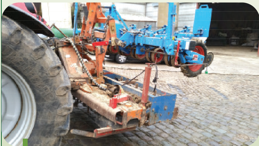
Figuur 12: De zaaimachine voor bieten en cichorei is bevestigd aan een aangepaste rotoeg. Zo komt het zaad terecht in vochtige grond.
