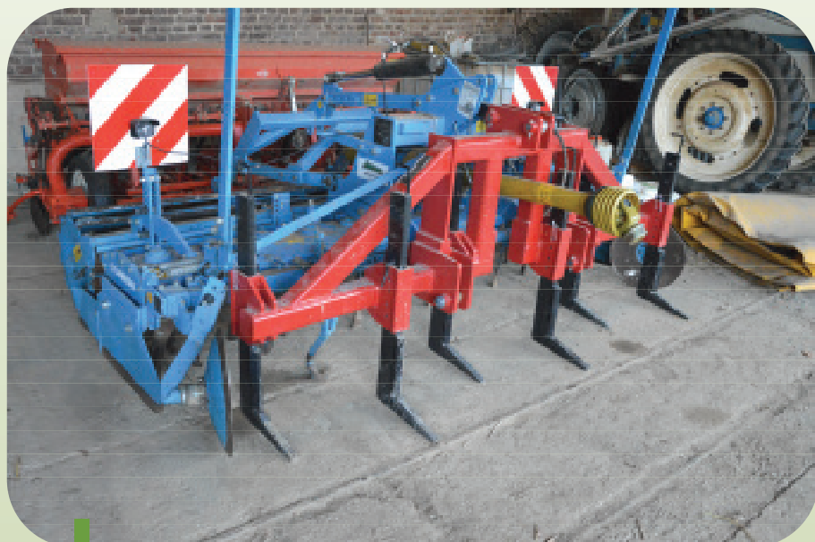
Figuur 13: Luc koos uiteindelijk voor een decompactor met verspringende tanden op één balk. Deze kan hij aankoppelen voor een rotoeg.
