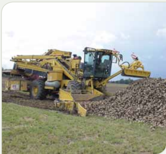
Figure 6. En Belgique, la majorité des tas est reprise à l'avaleuse. Cela implique que ces tas doivent être accessibles par tous les temps (et surtout par temps hivernal) pour les camions et l'avaleuse et être à l'écart des lignes électriques. La voie d'accès au tas doit être au moins empierrée, d'une largeur de 4 m, avec des bas-côtés stabilisés et des tournants praticables. L'endroit du chargement doit être au même niveau que la route d'accès et en accord avec le règlement routier local.
